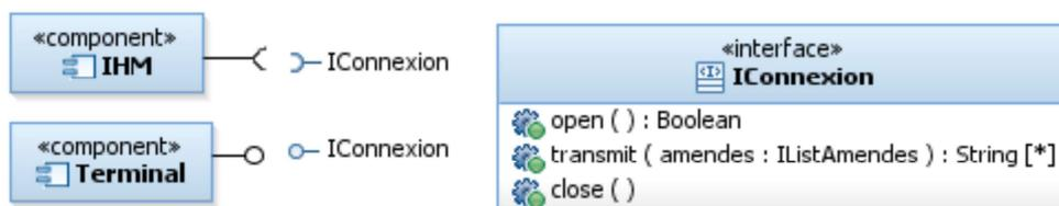
**open() : boolean** : démarre la connexion au terminal, on gère l'existence d'un problème avec un booléen pour éviter de modéliser des exceptions.
