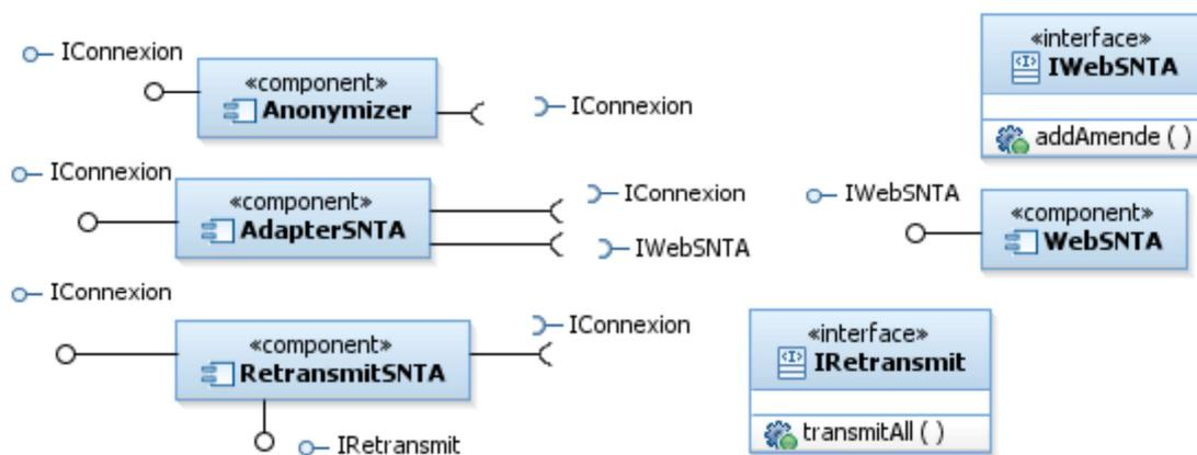
Un composant **Anonymizer** réalise le stockage dans la base locale des amendes anonymes, un composant **AdapterSNTA** réalise la transmission au SNTA ou en cas de souci de connexion au composant **RetransmitSNTA** de retransmission périodique. Ces trois composants vont être chaînés ; ils offrent et requièrent chacun l'interface `IConnexion`. Le composant **Anonymizer** sera connecté à l'IHM dans le déploiement final ; il constitue le point d'entrée du Terminal.
